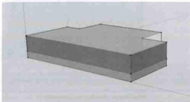
Le volume protégé d'un logement reprend tous les espaces du logement que l'on souhaite protéger des déperditions thermiques que ce soit vers l'extérieur, vers le sol ou encore des espaces non chauffés (cave, annexe, bâtiment mitoyen...). Il comprend au moins tous les locaux chauffés. Lorsqu'une paroi dispose d'un isolant thermique, elle délimite souvent le volume protégé.
